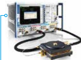
Измерение параметров пленок на основе резонатора
