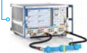
Измерение параметров материалов в волноводе
