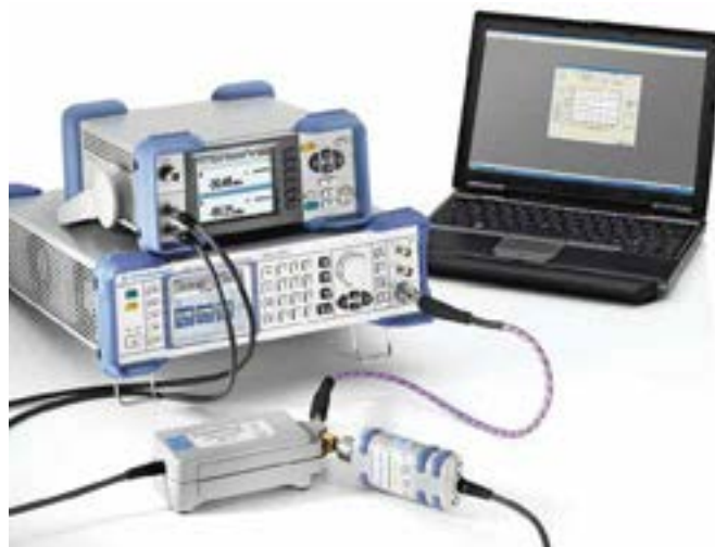
Измерительная установка для калибровки преобразователя мощности NRP-Z55
